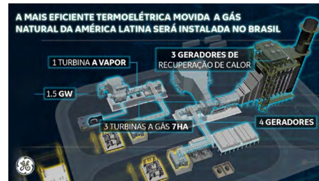
Figura: Imagem ilustrativa da Usina Termoeletrica Porto de Sergipe
